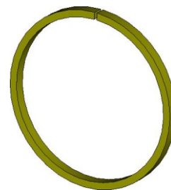
13. Поршневое кольцо цилиндра пушера ЦП-401-002-14
